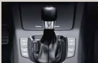
Transmisie automată în șapte trepte cu dublu ambreiaj (7DCT)
