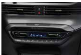
Instalație de climatizare automată.
