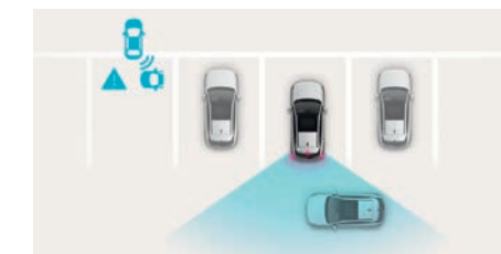
Sistem de asistență pentru evitarea unei coliziuni la deplasarea în marșarier (RCCA)
