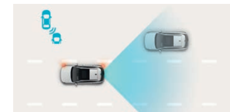
Sistem de asistență la evitarea coliziunilor în unghiul mort (BCA)
