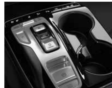
Tehnologie shift-by-wire. Poziționată ergonomic, consola centrală a fost reproiectată, utilizând tehnologia shift-by-wire.
