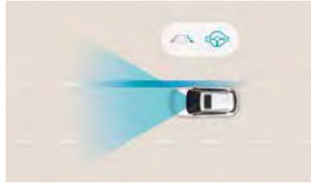
Sistem de asistență la menținerea benzii de rulare (LKA)
